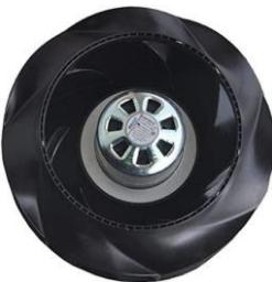
В оборудовании установлены надежные, высокoeffективные, ЕС-вентиляторы. Электронно-коммутируемые вентиляторы (ЕС) с управлением по линии 0-10в. ЕС-Вентиляторы регулируются в диапазоне от 20% до 100% с точностью в 1%, это позволяет максимально точно подвести воздухообмен к расчетным/проектным значениям. Приточный и вытяжной вентиляторы настраиваются раздельно, что позволяет балансировать приточную и вытяжную линии изменением настроек вентиляторов.
