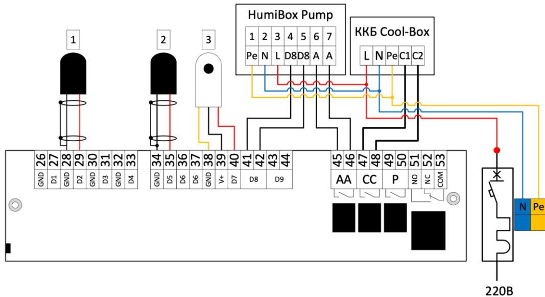
**1** Датчик температуры воздуха D2. Устанавливается в канал, подача в дом. Чёрный GND №28 , красный D2 №29
