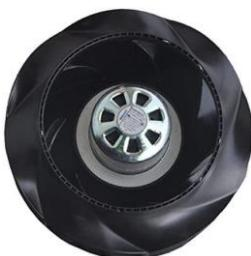
В оборудовании установлены надежные, высокоэффективные, ЕС-вентиляторы/ Электронно-коммутируемые вентиляторы (ЕС) с управлением по линии 0-10V. ЕС-Вентиляторы регулируются в диапазоне от 30% до 100% с точностью в 1%, это позволяет максимально точно подвести воздухообмен к расчетным/проектным значениям. Приточный и вытяжной вентиляторы настраиваются раздельно, что позволяет балансировать приточную и вытяжную линии изменением настроек вентиляторов.
