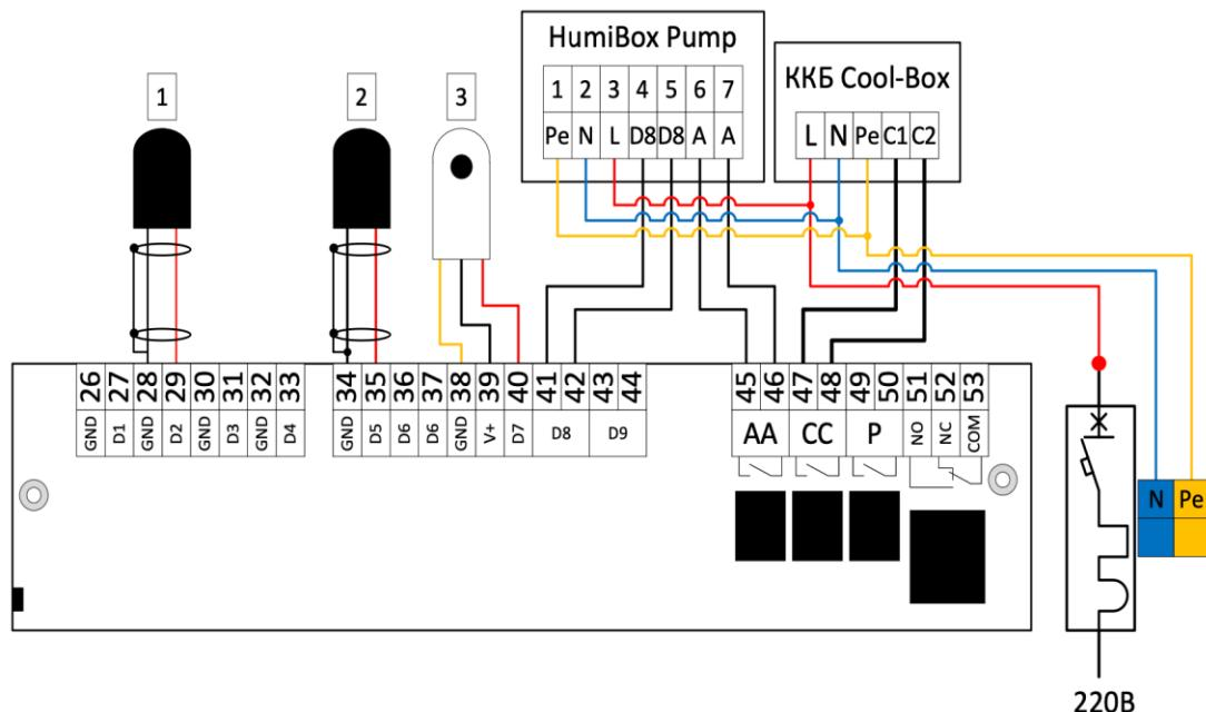
**1** Датчик температуры воздуха D2. Устанавливается в канал, подача в дом. Чёрный GND №28 , красный D2 №29
