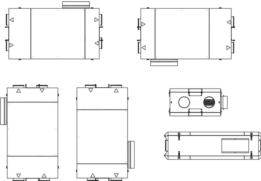
Оборудование с жидкостным нагревателем **ЗАПРЕЩЕНО** монтировать
