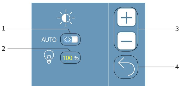
1. Кнопка выбора режима яркости экрана (левое положение — автоматическая яркость, правое положение — ручная настройка яркости).
