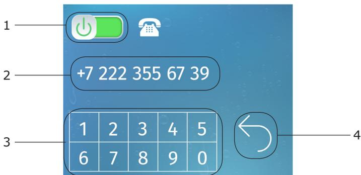
1. Кнопка-индикатор активации/деактивации отображения номера телефона техподдержки (отображается в окне уведомления об ошибке).
