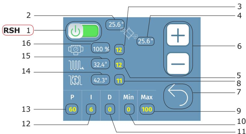
**RSH** – обрыв связи по RS485 с блоком реле. Если у вас имеется предварительный нагреватель, то проверьте соединение между блоком автоматики и блоком управления многоступенчатого нагревателя. В случае отсутствия - обратитесь в техническую поддержку.
