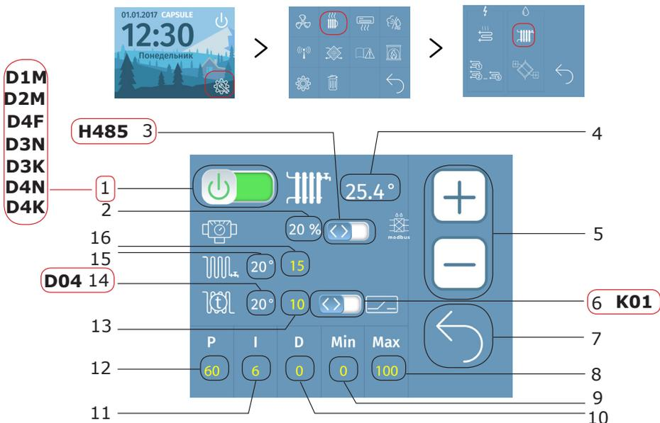
**D1M** – перегрев на датчике D1 (+50). Проверьте работу вентиляторов.
