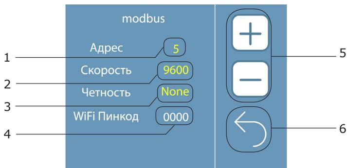
1. Редактируемое значение адреса устройства по интерфейсу **RS485** (modbus RTU).
