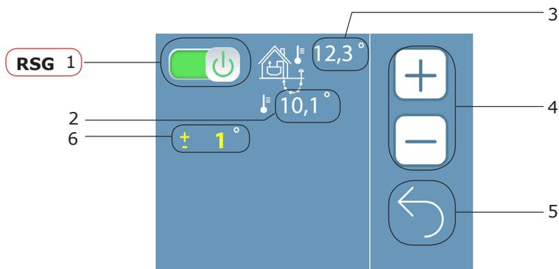
1. Кнопка-индикатор активации/деактивации блока геотермального контура.
