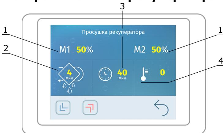
1 - Параметры **M1** и **M2** содержат скорости вентиляторов при просушке рекуператоров.
